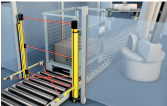
MLDSET, modèle T-Shape avec transceiver à 3 faisceaux sur un montant de 1 600 mm de haut, dans une application à inhibition temporelle à 2 capteurs
