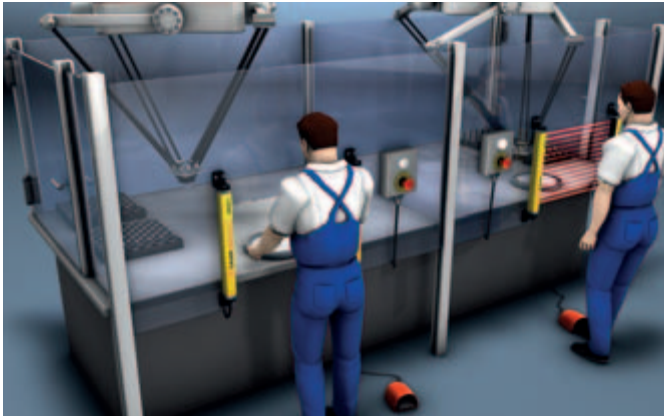
Commande de composants individuels de sécurité avec contrôleurs programmables de sécurité
