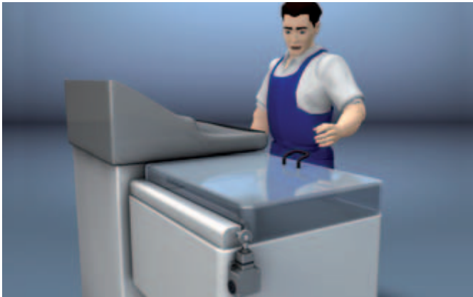
Interrupteur de position de sécurité sur une machine avec dispositif de protection et articulations tournantes - une application typique dans le domaine de l'usinage de pièces automatisé par exemple
