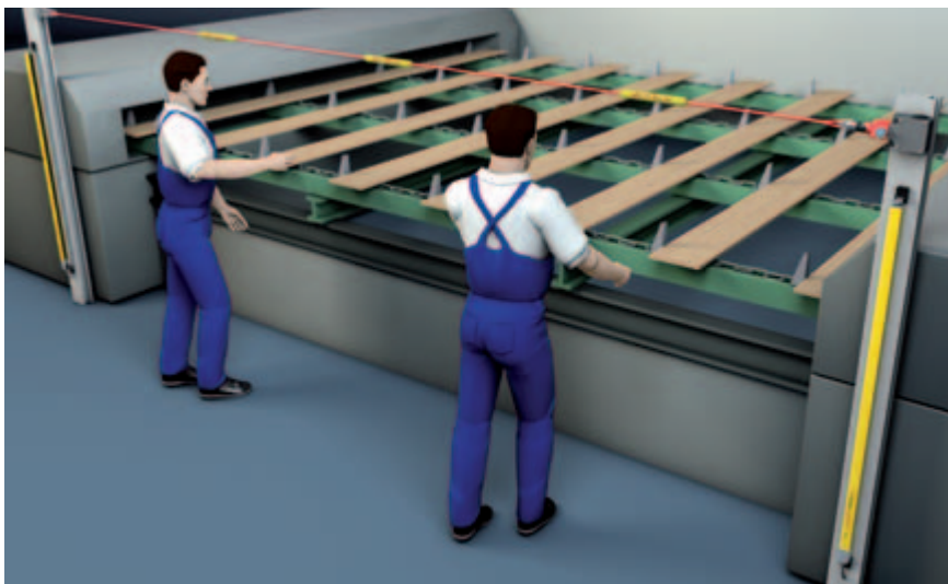
Interrupteur d'arrêt d'urgence à câble ERS200 en tant qu'appareil de commande de sécurité dans l'industrie de traitement du bois
