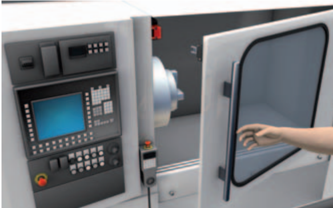
Interverrouillage de sécurité dans un centre d'usinage des métaux avec temps de mise à l'arrêt
