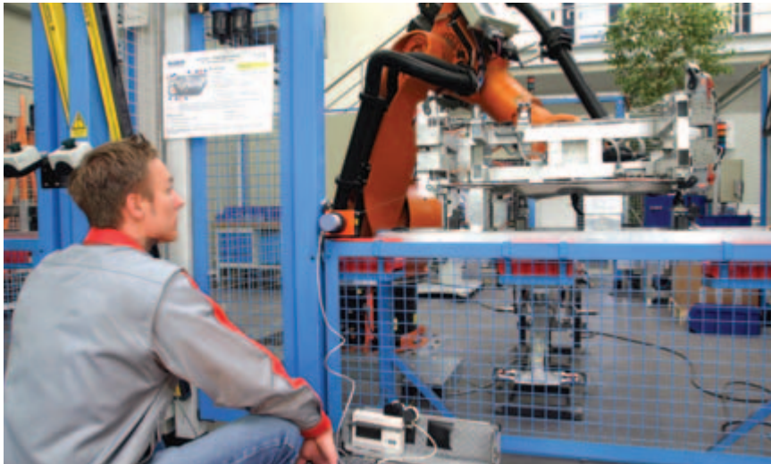
Nos mesures des temps d'arrêt constituent une base essentielle au positionnement adéquat des dispositifs de protection
