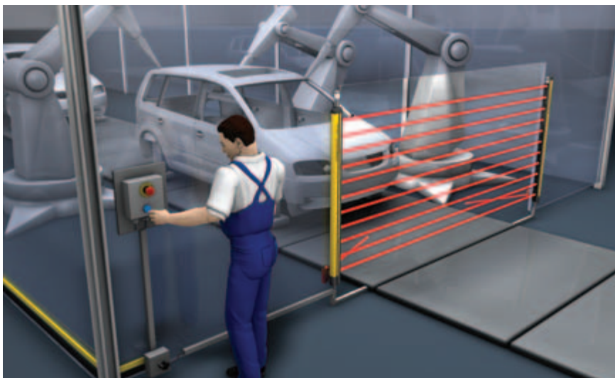
Sortie automatique de carrosseries de la zone de traitement grâce à l'inhibition
