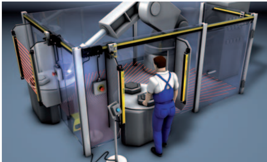
Application robot reposant sur l'AS-Interface Safety at Work avec 2 circuits de validation
