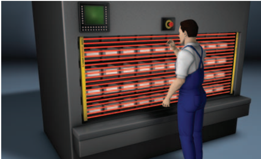
Sécurisation d'un ascenseur à étagères à l'aide d'une barrière immatérielle de sécurité SOLID-2E et d'un module relais MSI-RM2
