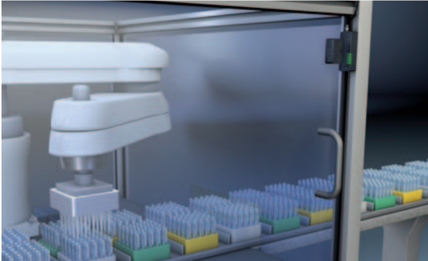
Emploi du transpondeur de sécurité RD800-S utilisé seul dans le domaine pharmaceutique, par exemple pour la sécurisation d'une cellule lors de l'analyse automatisée d'échantillons
