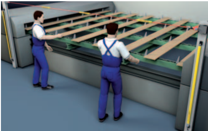
L'interrupteur d'arrêt d'urgence à câble ERS200 est employé comme appareil de commande de sécurité en cas de postes dangereux étendus.
