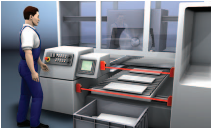
Sécurisation d'une machine à bois à l'aide d'un barrage immatériel monofaisceau de sécurité SLSR 46B
