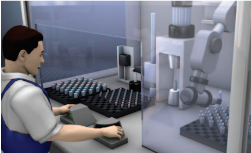
Intégration d'une commande bimanuelle dans le circuit de sécurité via un module d'extension de contacts MSI-CM
