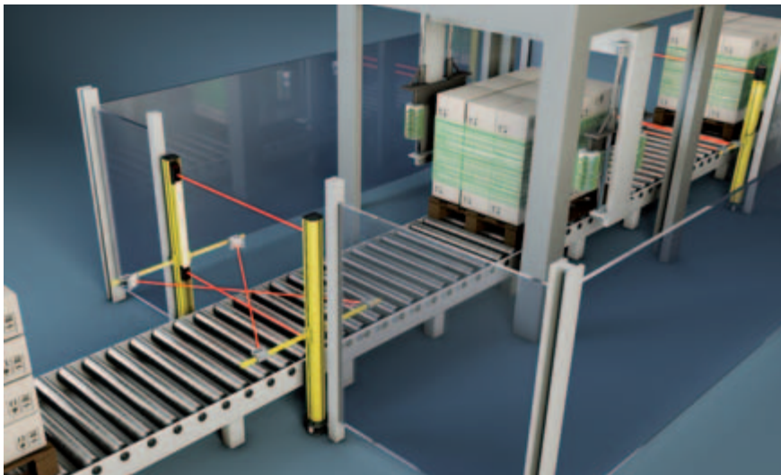
MLDSET à 2 faisceaux avec montant fermé par le haut dans une application à inhibition temporelle à 2 capteurs
