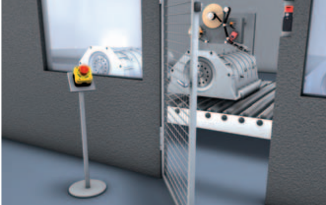
Le bouton d'arrêt d'urgence ESB200 est un appareil de commande de sécurité qui envoie une commande d'arrêt en cas de mouvement dangereux de la machine.
